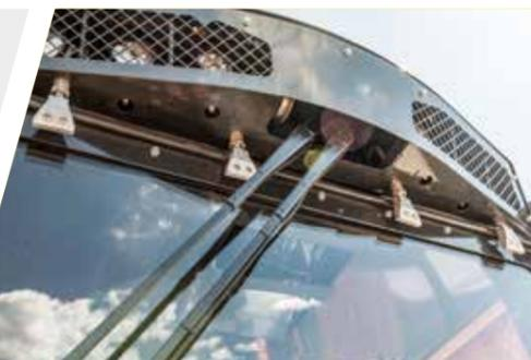
Système de nettoyage des vitres à air
