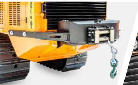
Treuil arrière avec capacité de traction de 6 t
