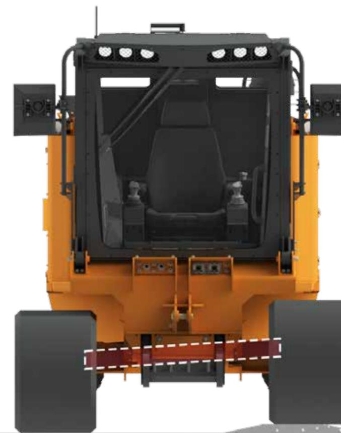
La technologie de **châssis oscillant** augmente l'adhérence et le confort
