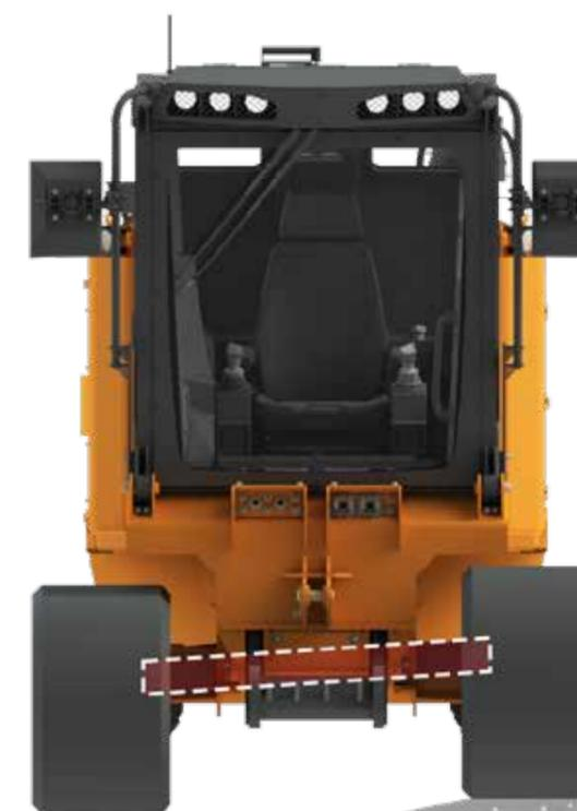
La technologie de châssis **oscillant** augmente l'adhérence et le confort
