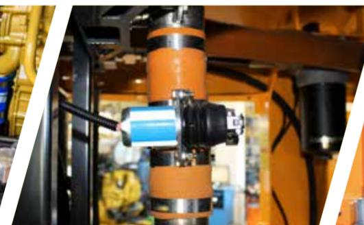
Système de coupure d'air
