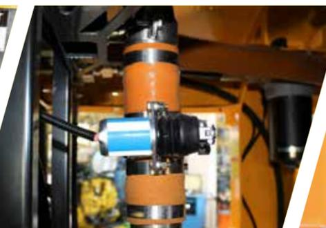
Système de coupure d'air
