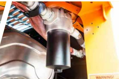
Filtre drainage (pack filtration robuste)
