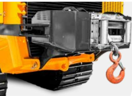
Treuil arrière avec capacité de traction de 6 t
