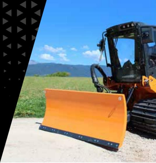
Mechanische oder hydraulische Drückevorrichtung (Option)
