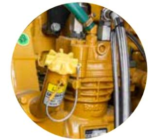
Der vorhandene **Luftkompressor** vereinfacht die tägliche Reinigung.
