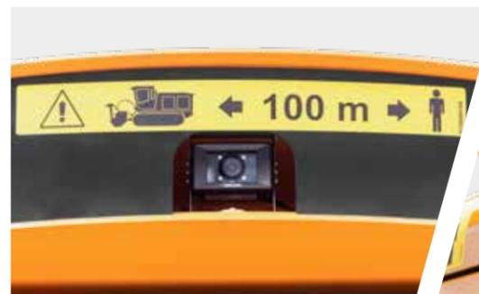
Heckkamera mit zusätzlichem LCD-Display (Paket Visibility)
