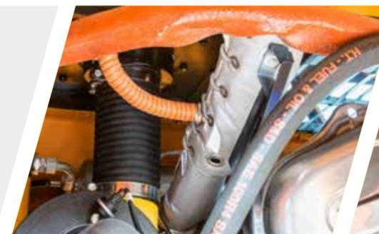
Ejektor (Paket Heavy Duty Filterung)
