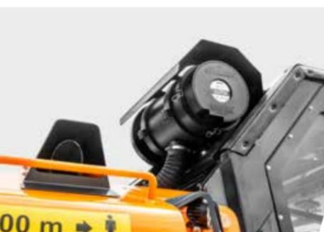
System zur Druckbeaufschlagung der Kabine
