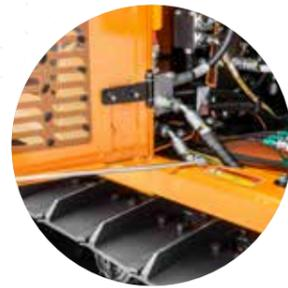
Die großen **hinteren Klappen** sind mit Sicherheitsfeststellern ausgestattet (2)
