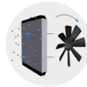
Der **Umkehrlüfter** erhöht die Effizienz des Kühlers.(4)
