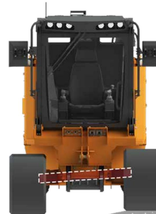
Das **Pendelfahrwerk** erhöht die Bodenhaftung und den Komfort.
