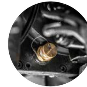
Die Anschlüsse ermöglichen es, die **Flüssigkeiten** schnell und ohne Verluste **abzulassen** (5)
