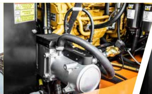
System zum Vorwärmen von Motor und Hydrauliköl
