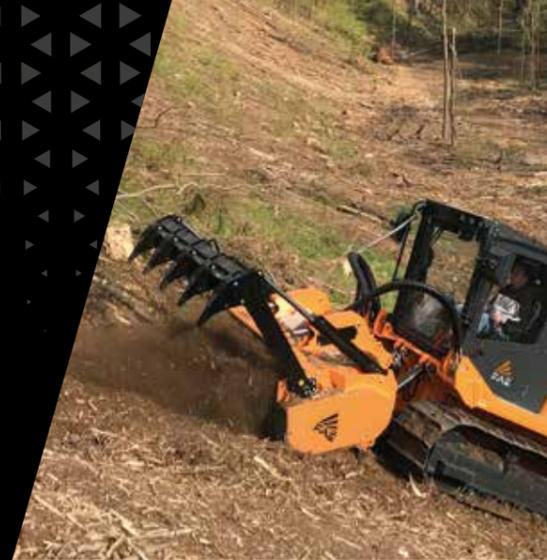
Mechanische oder hydraulische Drückevorrichtung (Option)
