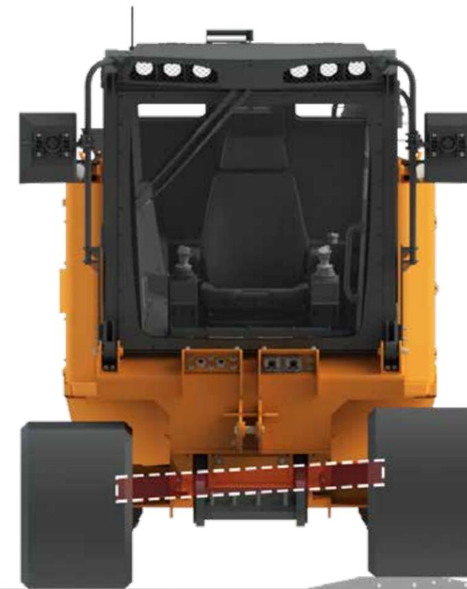
Das **Pendelfahrwerk** erhöht die Bodenhaftung und den Komfort.
