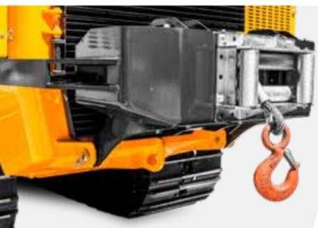
Hintere Seilwinde mit 6 Tonnen Zugkraft
