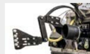
**Parallelsteuerung Typ W zwischen Getriebe und Kardanwelle**
