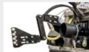
**Parallelsteuerung Typ W zwischen Getriebe und Kardanwelle**
