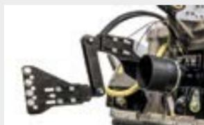
**Parallelsteuerung Typ W zwischen Getriebe und Kardanwelle**
