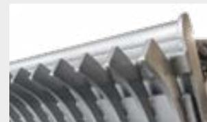
**Rückwärtiges Gitter an der Klappe** ermöglicht das Zurückhalten und erneute Brechen des grobkörnigeren Teils, um eine optimale Beschaffenheit des Materials zu erreichen
