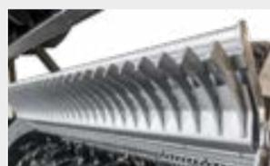
**Anschraubgitter für Heckklappe**
