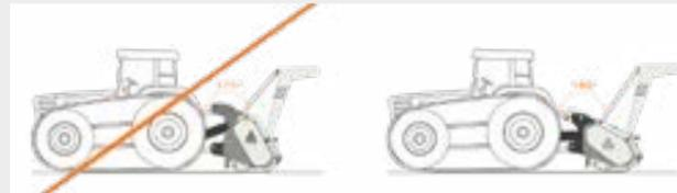
**Modell für Traktoren mit niedrig liegender Zapfwelle**
