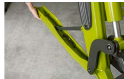
Die Stützen klappen einfach unter den Holm und behindern damit nicht die Sicht auf den Frontlader.
