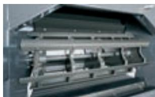
Le contre-batteur MULTICROP permet d'adapter rapidement la machine à différentes récoltes pour passer par exemple des céréales au maïs sans difficultés.
