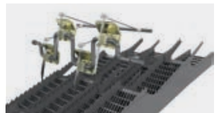
Kurbelwelle mit Rafferzinken zur Auflockerung der Strohmatte
