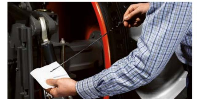
Die Getriebeölstandkontrolle erfolgt einfach am Heck.
