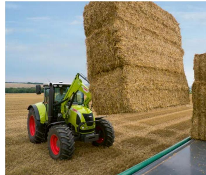
Der Frontkraftheber ist voll integriert und mit klappbaren Hubarmen ausgerüstet. Durch den geringen Abstand zwischen Koppelpunkt und Vorderachse profitieren Sie bei allen Arbeiten von einer präzisen Bodenführung. In Kombination mit der Frontzapfwelle ermöglicht der Frontkraftheber Ihnen ein außerordentlich vielseitiges Einsatzspektrum.
