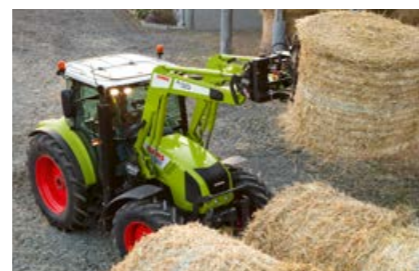
Le débit hydraulique maximum de 98 l/min assure la rapidité du travail au chargeur frontal.
