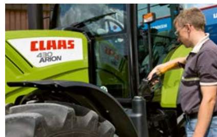
Les 175 l du réservoir à carburant de l'ARION 400 permettent d'espacer les pleins et donc les temps d'arrêt du tracteur.
