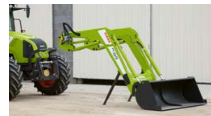
Le chargeur frontal CLAAS repose en toute sécurité sur l'outil et les béquilles.
