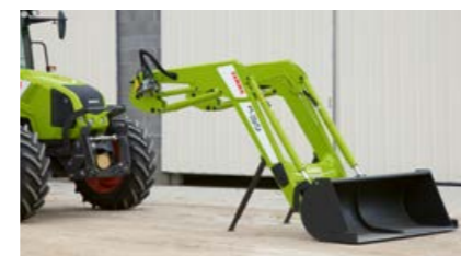
Der CLAAS Frontlader steht sicher auf dem Werkzeug und den Stützfüßen.
