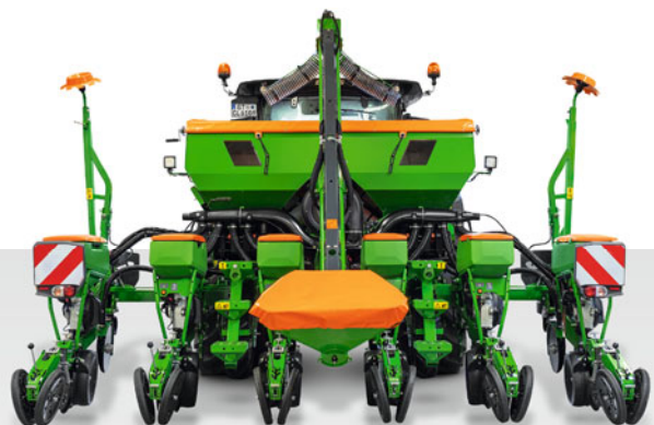
Precea 4500-2CC et son châssis télescopique variable avec largeur de travail intégrale
