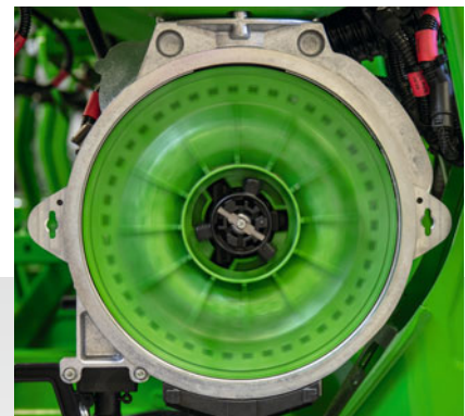
Vereinzlungsscheibe in Betrieb (ohne Deckel)
