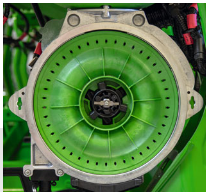
Eingesetzte Vereinzlungsscheibe im Stillstand
