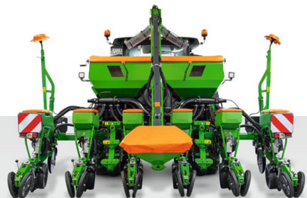
Die Precea 4500-2CC mit ihrem variablen Teleskoprahmen bei voller Arbeitsbreite
