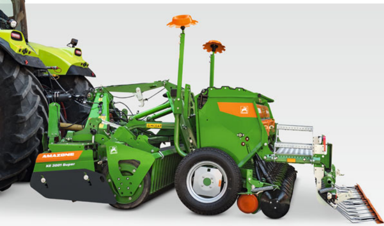
Herse rotative KE 3001 Super avec système Portacourt et semoir porté accouplé D9 3000
