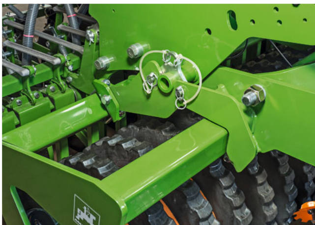
✓ Système de couplage rapide QuickLink – Processus de couplage plus simple, plus rapide et sans outils
