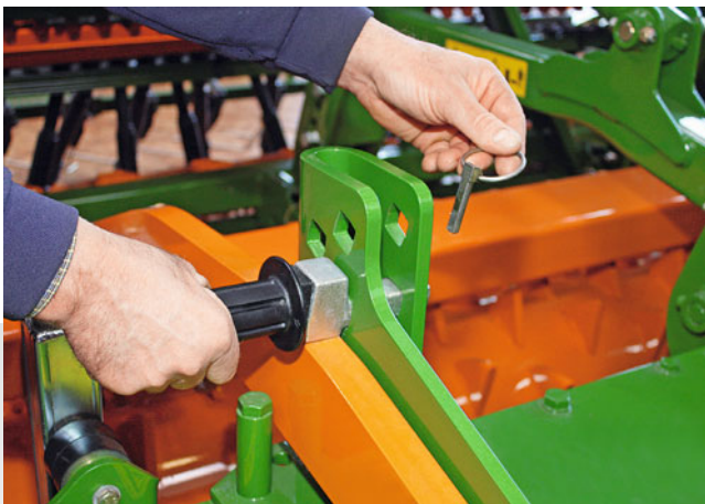
✔ Réglage mécanique de profondeur
