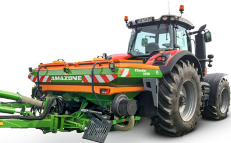
Trémie portée XTender 2200 avec un volume de trémie de 2 200 l
