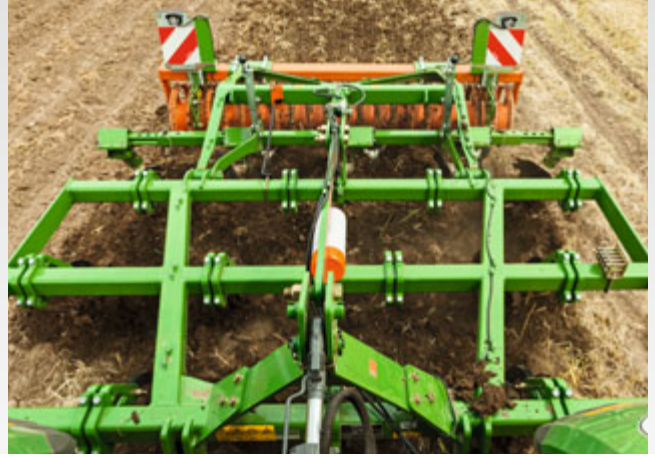
Structure du châssis sur 3 rangées du Cenius 3003 Special
