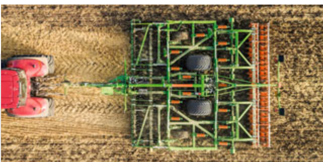
Derrière chaque roue, la dent fait office d'efface traces
