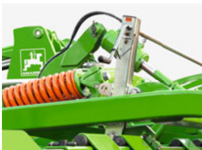
Réglage de hauteur des éléments de nivellement par manivelles sur Cenius TX
