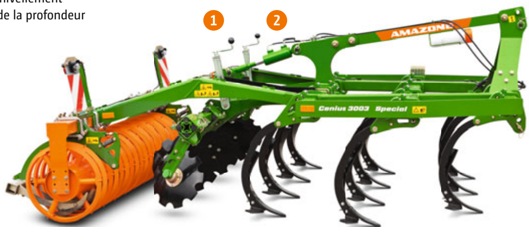
Cenius Special : dents C-Mix avec sécurité de surcharge par boulon de cisaillement et rouleau profil angulaire
