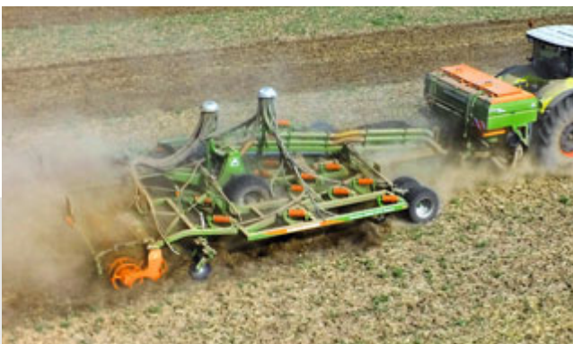
XTender 4200 avec Cenius 6003-2TX et deux voies d'alimentation pour appliquer l'engrais et la semence
