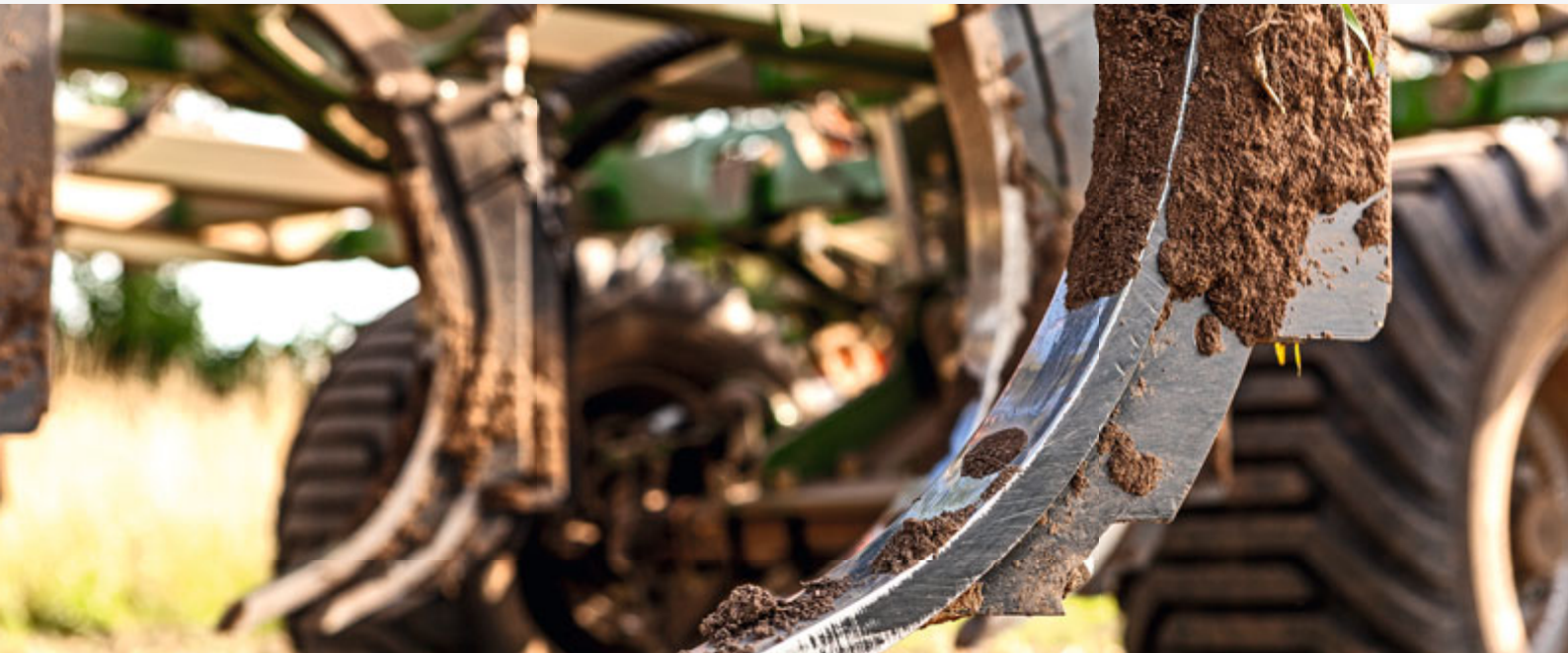
Soc C-Mix 40 mm avec dents d'application d'engrais pour le Cenius-2TX
