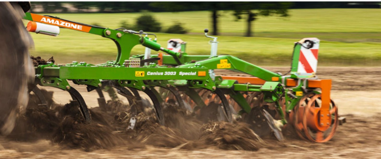
Cenius 3003 Special avec dents C-Mix-Special
