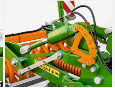
Hydraulische Arbeitstiefeneinstellung mit gut lesbarer Skala
