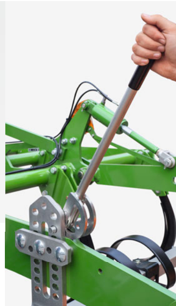
Manuelle Einstellung der Einebnungseinheit über Lochraster
