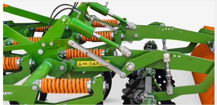
Automatische Anpassung der Einebnungseinheit
