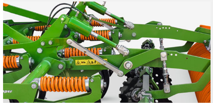
Adaptation automatique de l'unité de nivellement
