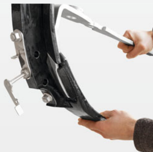
Avec le système de socs C-Mix-Clip
