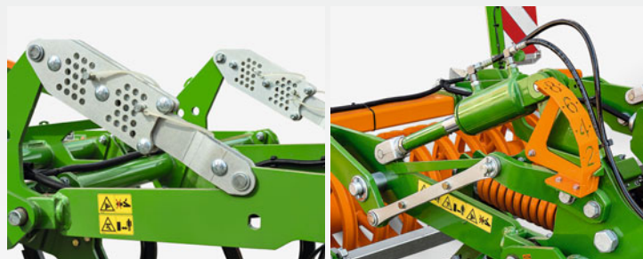
Réglage mécanique de la profondeur de travail
