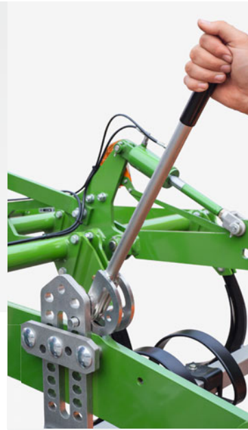
Réglage manuel de l'unité de nivellement via segment perforé
