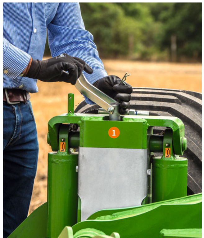
Arbeitstiefeneinstellung am Aufsattelrad
