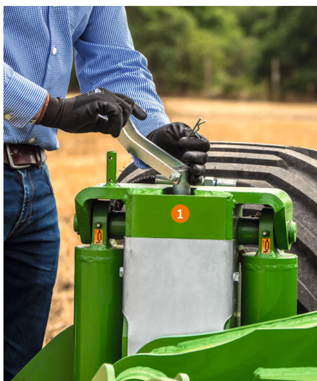
Réglage de la profondeur de travail et de la roue
