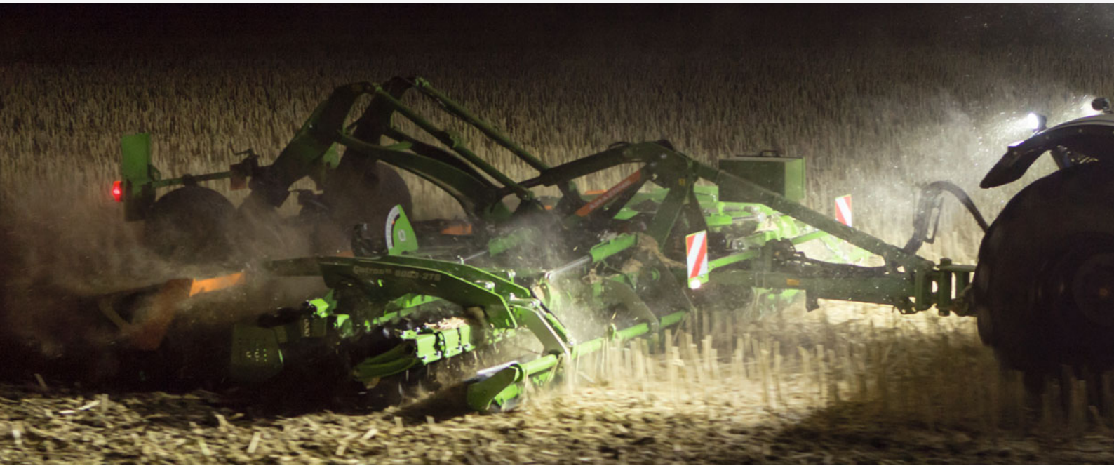
Catros XL mit Messerwalze in Rapsstoppeln
