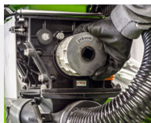
Einfacher Wechsel der Dosierwalze
