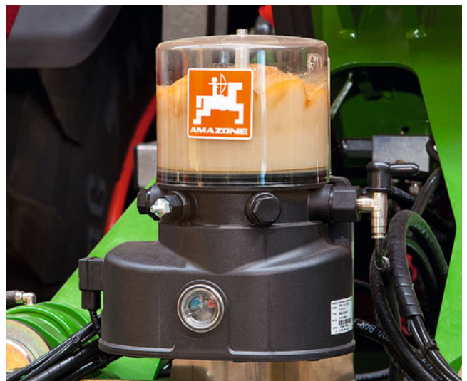
Pumpe mit Vorratsbehälter
