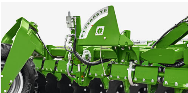
Hydraulische Arbeitstiefenverstellung mit gut ablesbarer Skala
