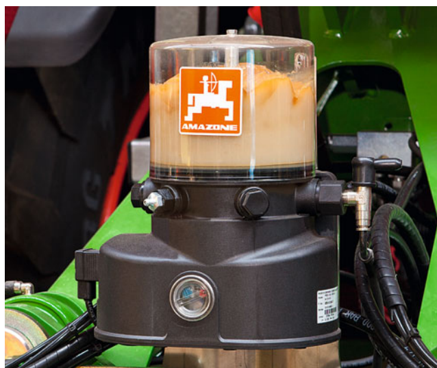
Pompe avec réservoir de stockage
