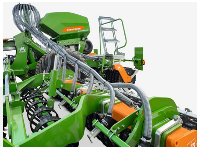
Flexibilité élevée grâce à la tête de distribution segmentée
