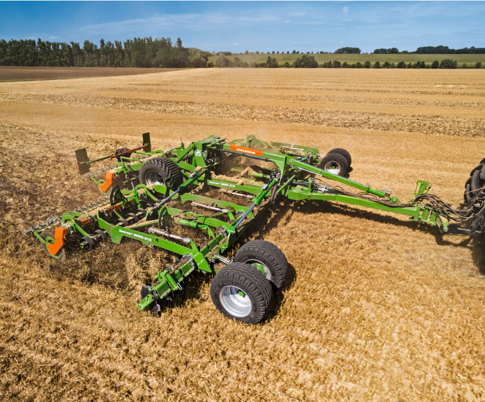
Catros + 8003-2TX avec rouleau rayonneur et pneus à profil Matrix en largeur de travail 8 m
