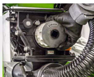
Changement simple des bobines de dosage
